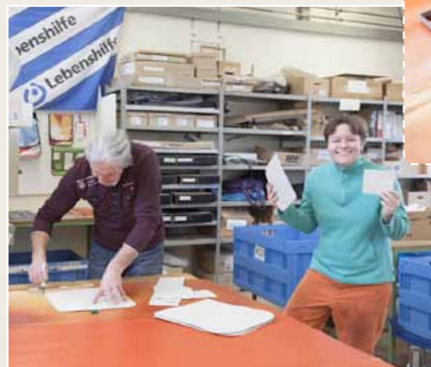
3 Wie bekommt die Tasche ihre Form? Die Mitarbeiter zeichnen die Umrisse mit Schablonen ab, dann stanzen sie die einzelnen Elemente mit extra gefertigten Stanzeisen.
