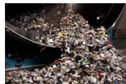
Nach vielen Schritten: Zerkleinerte Materialien – bereit für die Trennung nach den verschiedenen Stoffen.
